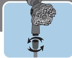
L'adaptateur d'évier s'adapte à deux tailles courantes de robinet après avoir retiré l'aérateur : femelle 22 mm (55/64 po) et mâle 24 mm (15/16 po).
